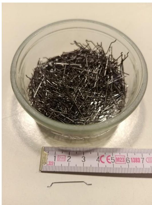
Slika V-7. Čelična vlakna sa kukicama – jedna od najčešće korišćene mikroarmature
