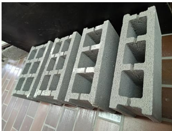
Slika II-3. Predmetni presovani elementi za zidanje od običnog betona
