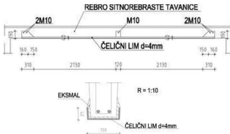
Slika 11- Detalj ojačanja sitnorebraste tavanice limom i eksmalom
