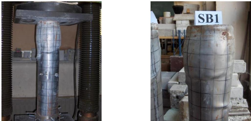
*Slika 10: Model stuba grupe SB nakon ispitivanja*
