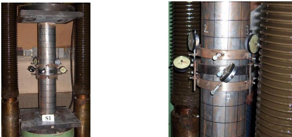
Slika 2. Model kontrolnog stuba neposredno pre ispitivanja
