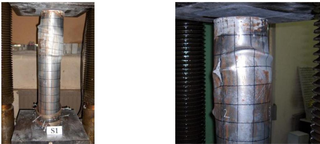
Slika 4. Model stuba S1 nakon ispitivanja
