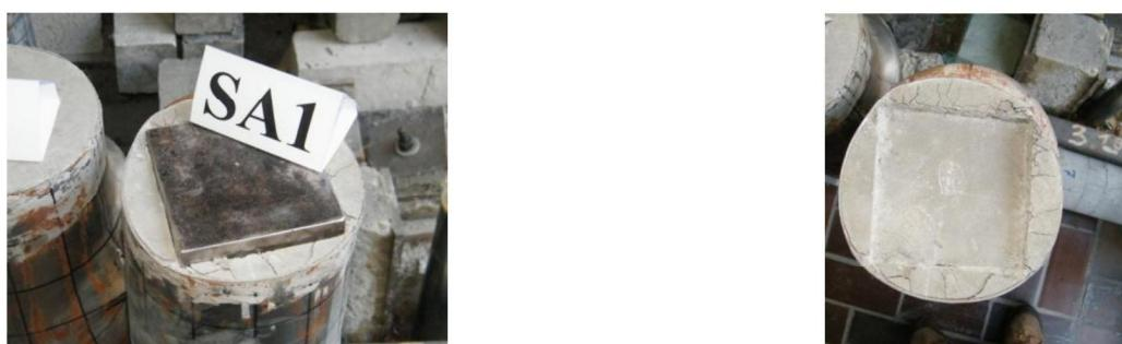
Slika 8: Vrh stuba neposredno nakon ispitivanja
