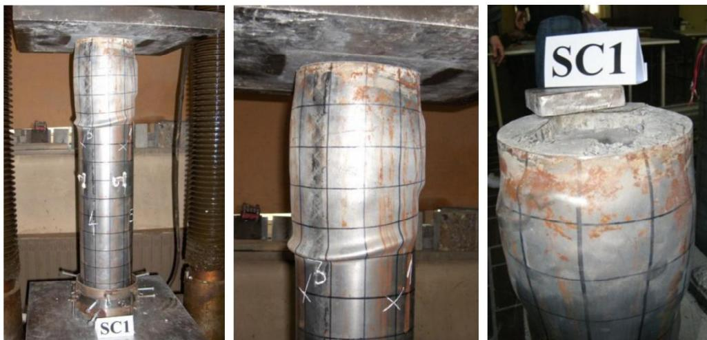
Slika 12: model stuba grupe SC nakon ispitivanja
