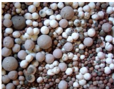
Slika 5 – „Geofil Bubbles“ – ekspanzirani stakleni agregat za lake betone[8]
