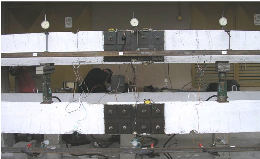
Slika 9. Spojeni nosači tokom ispitivanja
