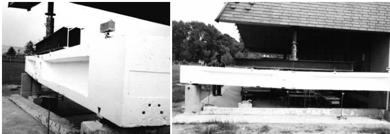
Slika 13. Fotografija spojene grede neposredno pre ispitivanja
